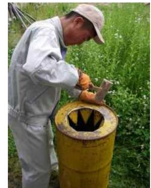
本体の作製にはプラズマカッターを用いました。プラズマカッターはアーク溶接に似た原理で、材料をアークで高温に溶かし切断します。今回は切断後、ペビーサンダーでさらに放射状に切断し、材料を折り曲げて煙突等をつけました。
